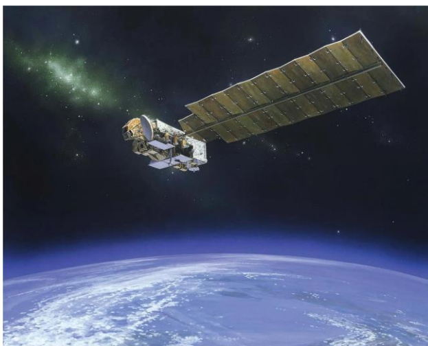
Рисунок 8. Спутниковый инструмент MLS Aura [ https://clck.ru/3QrtsN ]
