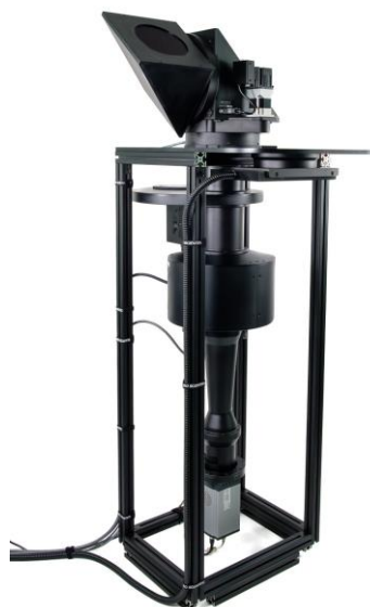
Рисунок 10. Интерферометр Фабри-Перо [ https://clck.ru/3QrtjY ]
