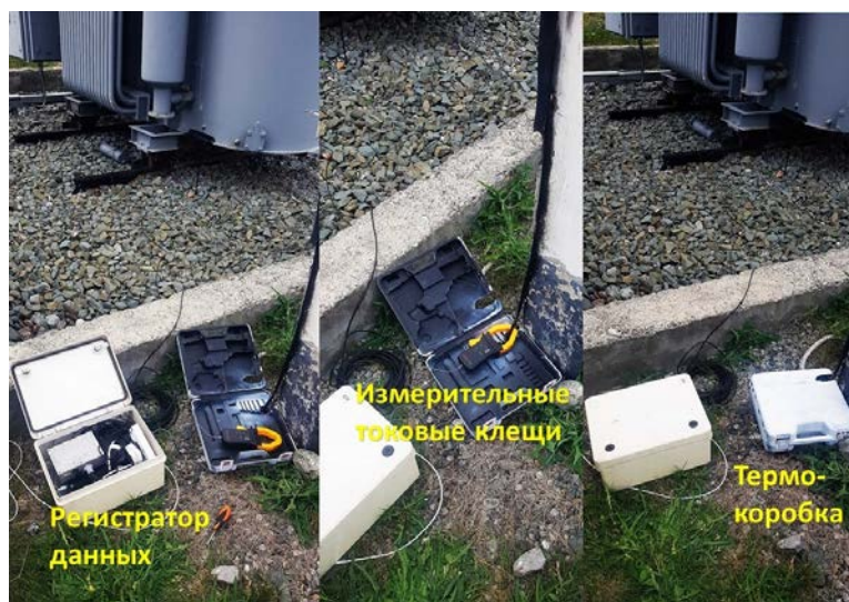
Рис. 4. Размещение токового датчика на шине заземления силового трансформатора установленной мощности 2.5 МВА на подстанции «Ининская»
