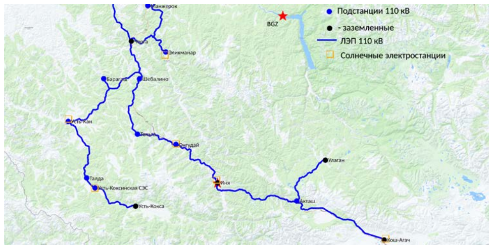
Рис. 2. Схема сети электроснабжения с напряжением 110 кВ центральной и южной частей Республики Алтай. Звездами показано расположение точек мониторинга геомагнитных вариаций (BGZ) и амплитуды четных гармоник переменного тока и ГИТ в сети электроснабжения Республики Алтай (Иня)
