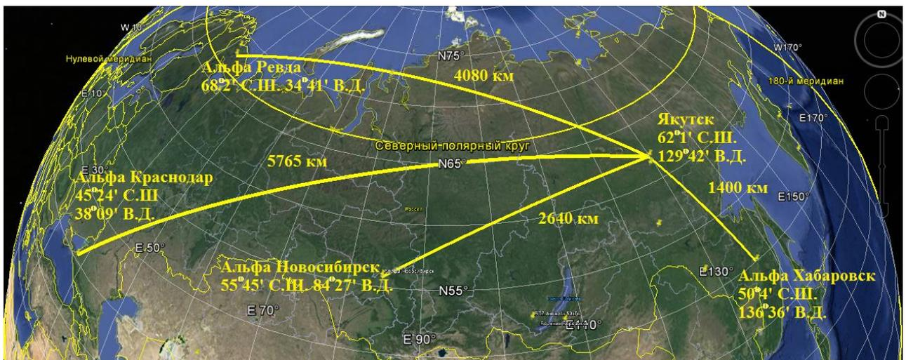
Рисунок 2.13 – Трассы распространения радиосигналов передатчиков РСДН-20 при приеме в Якутске
