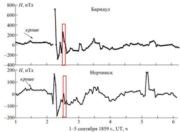
Рис. 1. Часовые значения отклонений от среднего *H*-компоненты магнитного поля 1–5 сентября 1859 г. для ст. «Барнаул» и «Нерчинск» [Тясто и др., 2009] и временной интервал наблюдения полярного сияния в Иркутске [Чернигов, 2003] (выделен красным прямоугольником)
