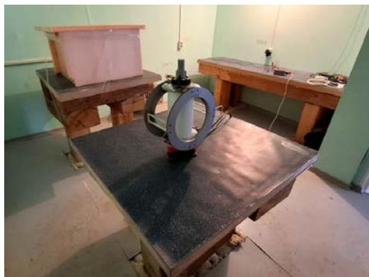
Рис. 3.7.2. Скалярно-векторный магнитометр POS-4 в вариационном павильоне КМИС
