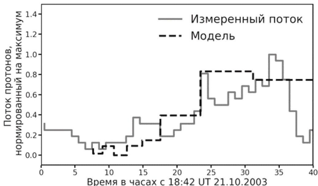
Рис. 2.3.1.3.1. Сравнение модельного и наблюдавшегося временных профилей для события в СКЛ 21 октября 2003 г.
