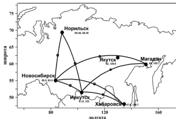
Рис. 2.2.2.2.1. Трассы слабонаклонного зондирования ионосферы в окрестности г. Иркутска (слева) и трассы наклонного зондирования в Азиатском регионе России (справа)
