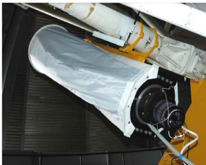
Рис. 2.3.1.6.1. Зеркальный Райт со светозащитным тентом на монтажке телескопа АЗТ-33ИК
