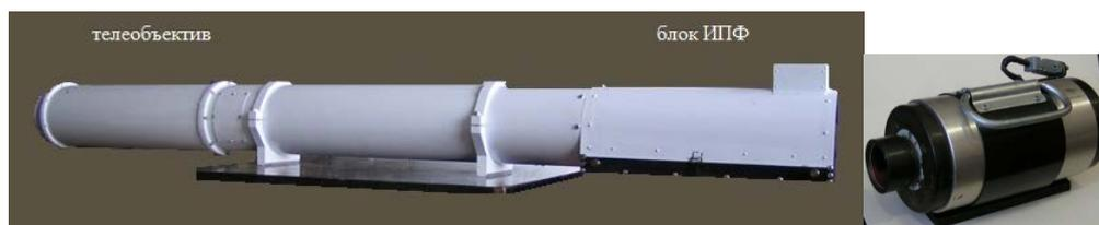
Рис. 2.3.1.1.2. Гид-искатель и интерференционно-поляризационный фильтр ИПФ-1М
