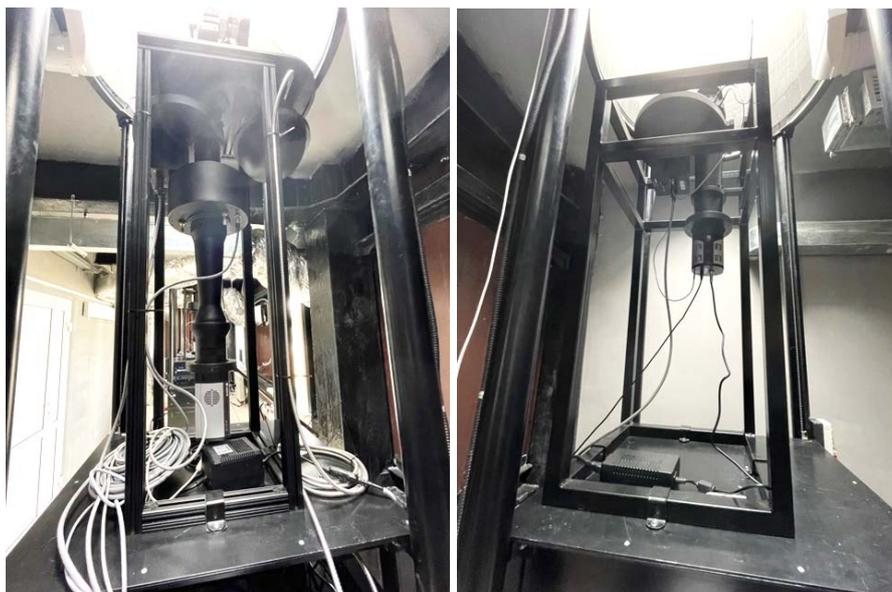
*Рис. 1.3.* Интерферометр Фабри—Перо (слева) и камера всего неба (справа) на подъемнике в северной комнате технического корпуса
