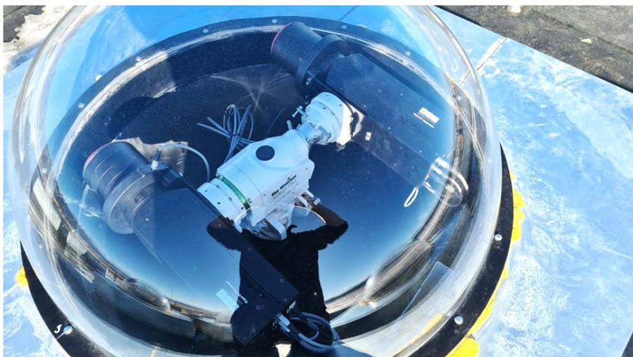
Рис. 1.7. Двухканальный фотометр в подкупольном пространстве.
