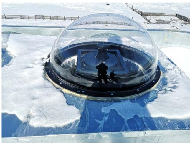
*Рис. 1.4.* Камера всего неба в подкупольном пространстве
