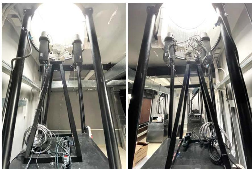
*Рис. 1.6.* Двухканальные фотометры на подъемниках в южной комнате технического корпуса
