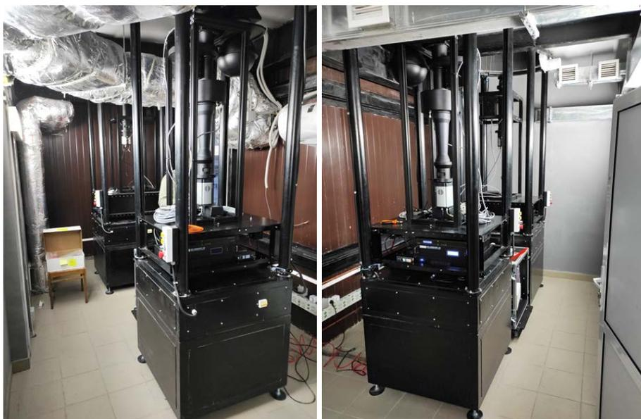
*Рис. 1.2.* Интерферометры Фабри—Перо (на переднем плане) и камеры всего неба (на заднем плане) в северной комнате технического корпуса
