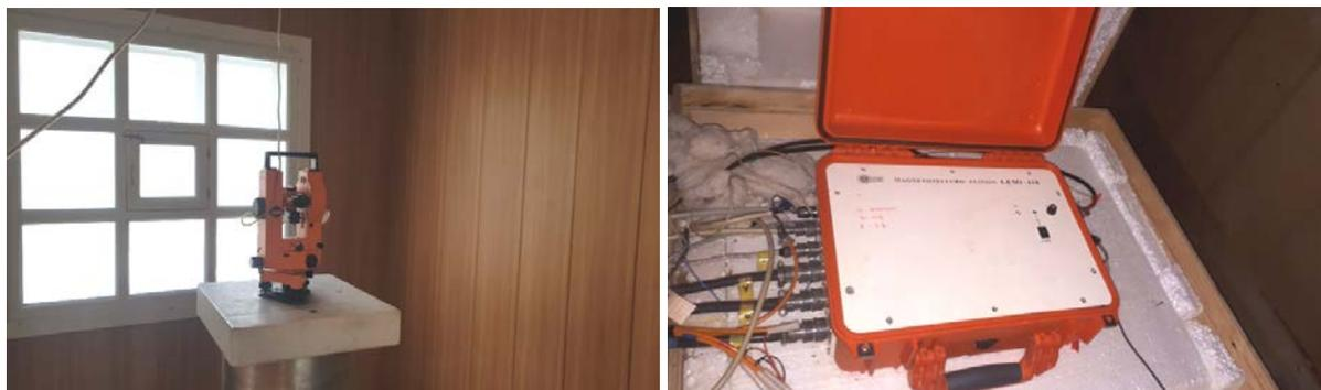
Рис. 3.6.1.2. Инклинометр/деклинометр MAG-001 (слева) и трехкомпонентная феррозондовая станция Lemi-018 (справа)
