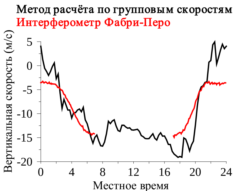
Рис. 2.3.1.1.1. Суточные вариации вертикальной скорости нейтрального ветра, полученные независимыми методами
