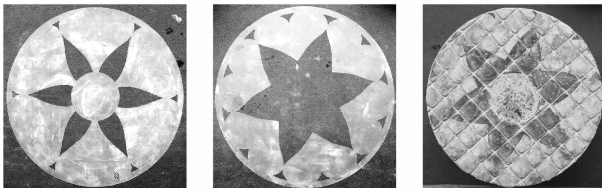
Рис. 2.4.1.6.2. Маски и полирующий инструмент. Слева — первая маска для достижения требуемой глубины рельефа planoидной поверхности, в центре — одна из масок для доводки planoидной поверхности на конечных стадиях изготовления, справа — отформованный полирующий инструмент
