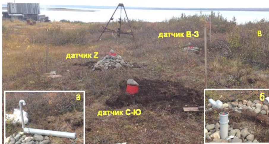
Рис. 3.7.2. Укладка индукционных датчиков (а, б) и панорама установленных датчиков индукционного магнитометра (в)
