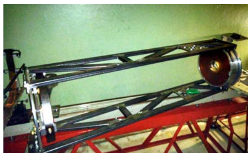
Рис. 2.4.1.5. Результаты расчета максимальных смещений конструкции фермы под действием силы тяжести с помощью метода конечных элементов (слева) и изготовленный каркас фермы с зеркалами в оправках (справа)
