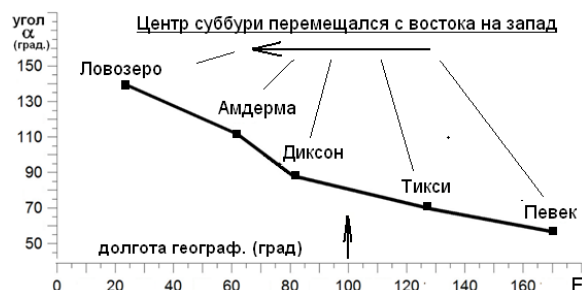
Рис. 2.3.8.2.2. Зависимость угла наклона главной оси эллипса поляризации Pi2 -колебаний от долготы развития суббури
