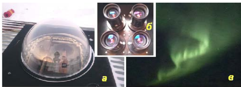
Рис. 3.7.3. Четырехканальный фотометр на кремниевых фотоумножителях (б), установленный в оптический купол (а) и зарегистрированная дуга полярных сияний (в)
