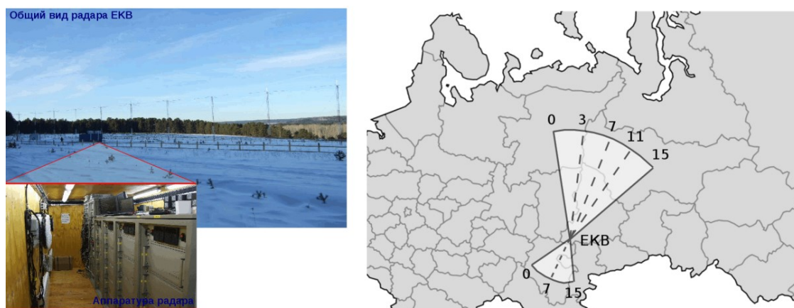
Рис. 22. Общий вид радара ЕКВ и его приемо-передающей аппаратуры (слева) и сектор обзора (справа), цифрами обозначены номера лучей.
