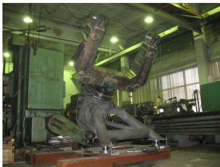
Рис. 77. Вилочная монтировка СОЛСИТ (вилка с призмой узла часовой оси) во время тестовых испытаний в экспериментальном цехе ИСЗФ СО РАН (октябрь 2013 г.).
