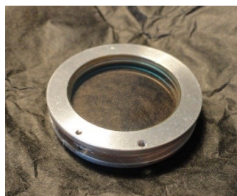
Рис. 78. Электрооптический модулятор на основе DKDP: 1 – кристаллическая пластинка DKDP; 2 – токопроводящее покрытие; 3 – Г-образные контактные кольца; 4 – токопроводящее покрытие на контактных кольцах; 5 – индиевая прокладка; 6 – оправа модулятора; 7 – окна из оптического стекла.
