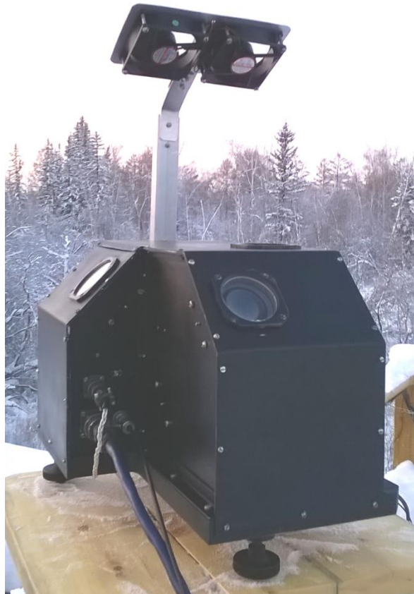
Рисунок 2.4. Четырехканальный фотометр для регистрации быстрых вариаций интенсивности молекулярных полос N_2^+
