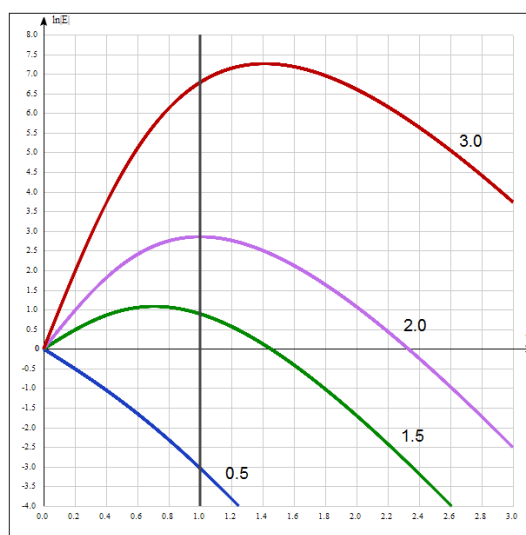
Рисунок 2. Зависимость логарифма амплитуды волны |E| от времени при разных отношениях \gamma/\delta (указано около кривых). По вертикальной оси — условные единицы (логарифмический масштаб), время t нормировано. Построение выполнено для азимутального волнового числа m=50 . Вертикальная прямая разделяет области преимущественно полоидальной (слева от нее) и тороидальной поляризации волны.
